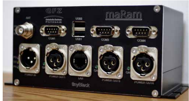
GNSS-Empfänger „tinyBlack“. (Foto: Markus Ramatschi/GFZ)
